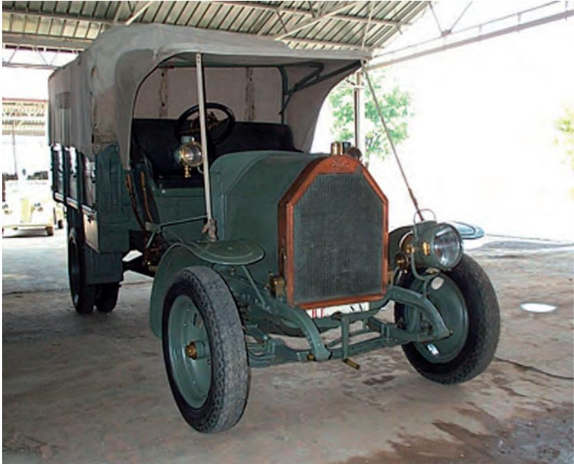
Autocarro Fiat 15 ter (1911). Motore: 4 cilindri in linea, cilindrata 4398 cm<sup>3</sup>.
