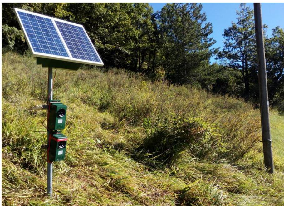
*Figura 179 – Dissuasori ad ultrasuoni accoppiati a video-foto-trappola (sul palo) nel sito di sperimentazione*
