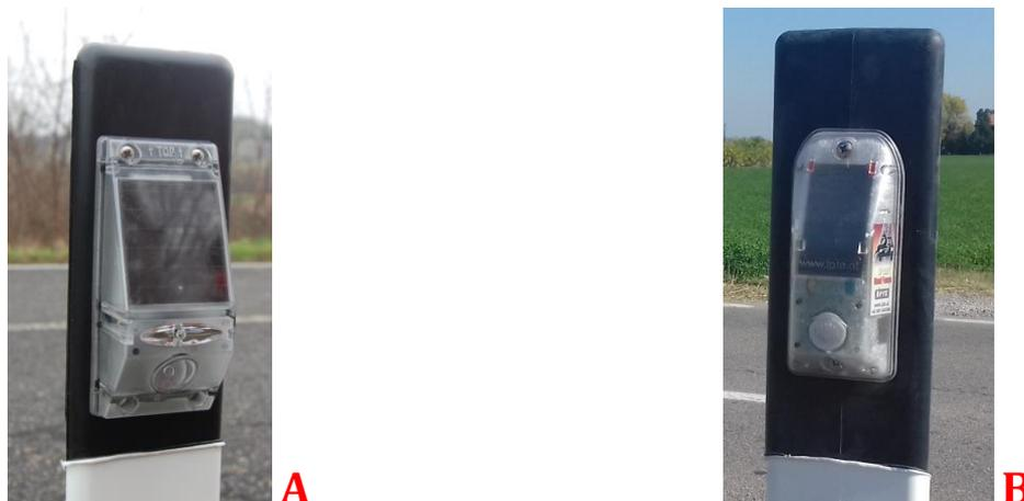
Figura 181 – Dissuasori elettronici di diverso modello (A e B) impiegati nell'ambito del progetto sperimentale in corso in Emilia- Romagna ([Sperimentazione Regione Emilia-Romagna](#)).
