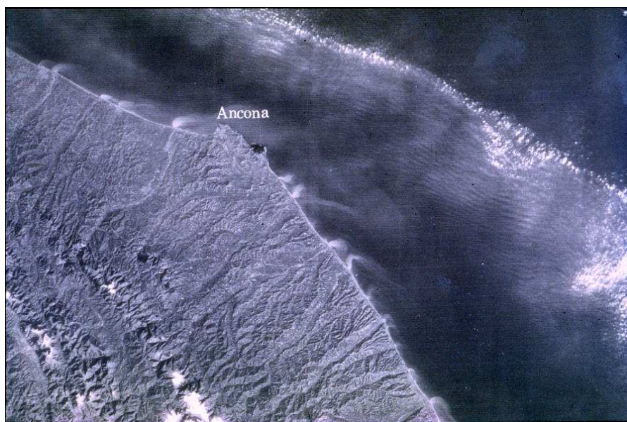
Figura 34 - Esempio di trasporto solido da parte della rete idrografica della regione Marche
