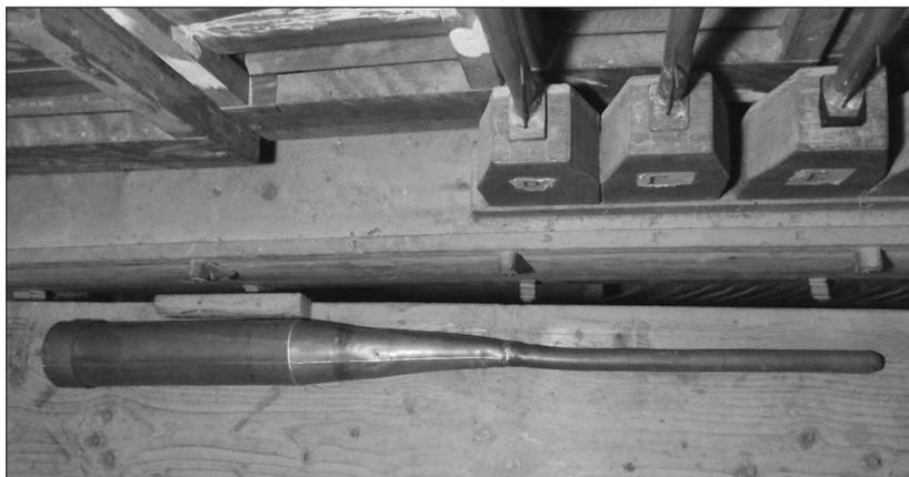
*fig. 6.* Canna del Flauto Traverso di 8' nei soprani nell'organo di Francesco Cioccolani (1833) a Monte Roberto. Si noti il piede allungato con un cannello cilindrico per innalzare la canna sopra le altre e ovviare allo spazio ristretto su somiere e crivello.
