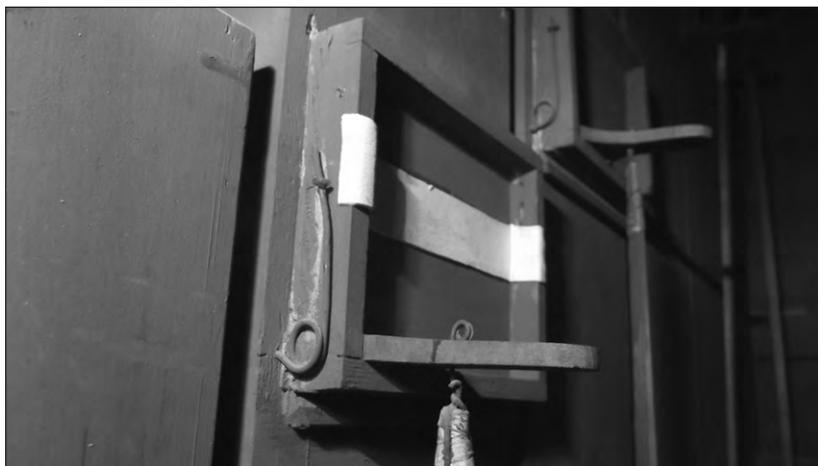
*fig. 9.* Valvole tonali sulle pareti delle canne lignee di basseria nell'organo di Odoardo Cioccolani (1879) a S. Ginesio.
