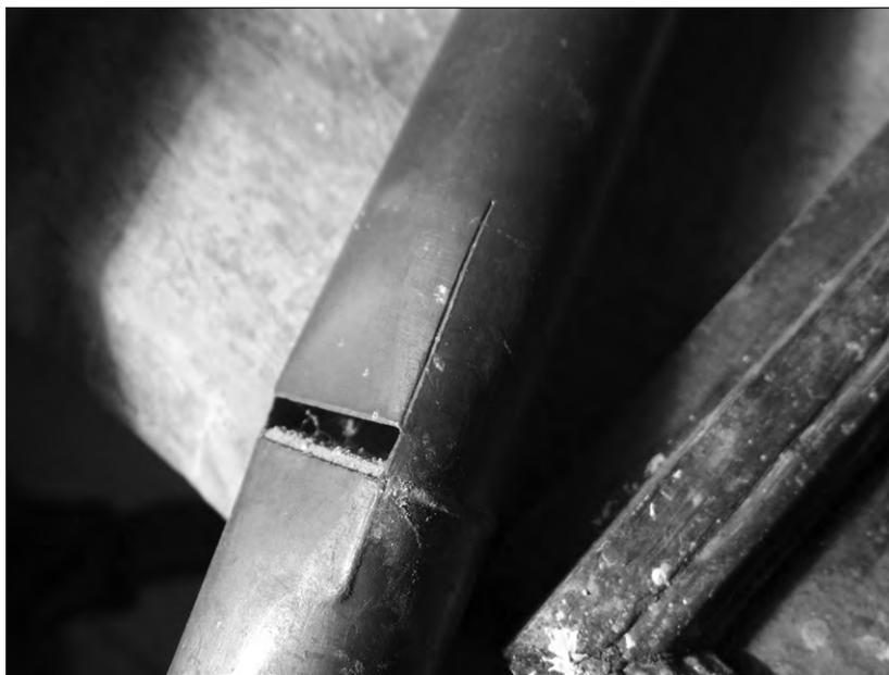
*fig. 5.* Errore di montaggio in una canna dell'organo di S. Domenico a Cingoli. Il corpo della lastra è stato arrotolato e saldato sulla faccia interna, dove si nota la tracciatura a secco della bocca.
