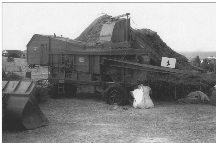
“Lu cintò” che collega il trattore alla trebbia e trasmette il movimento.
