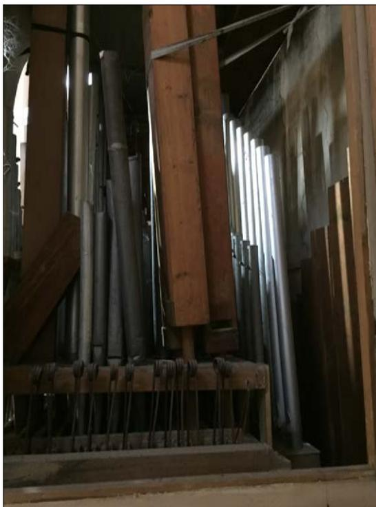
*Particolare delle canne interne sul somiere maestro che testimoniano lo stato di decadimento dello strumento.*
