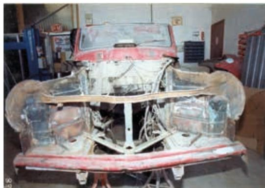
foto 32. Lo smontaggio del motore.
