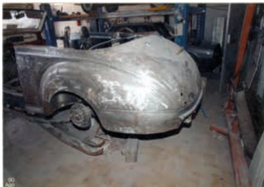
foto 33. La rimozione della vecchia vernice.
